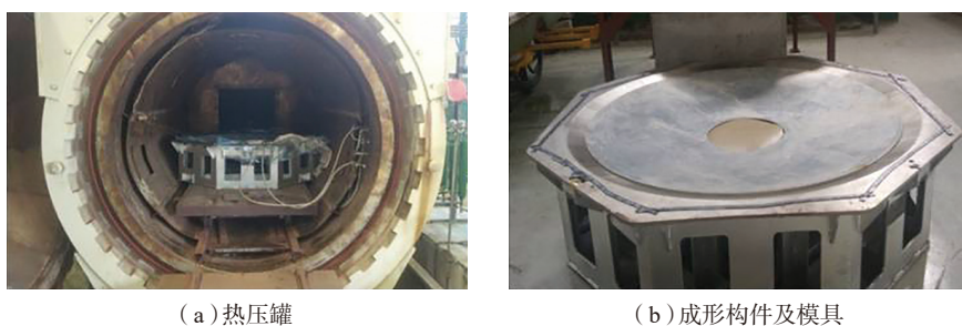
图7 顶盖应力松弛时效成形试验设备及成形构件和模具
